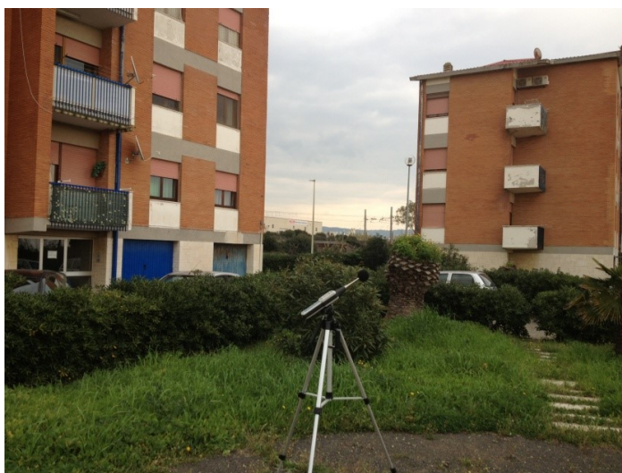
Fonometro BI-LAB. a circa 10 m di distanza dall’edificio lato nord
